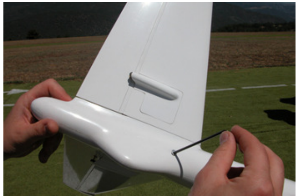
Une vis BTR qui se visse en bout de la clé avant maintient le demi-stab parfaitement plaqué sur le fuselage.
