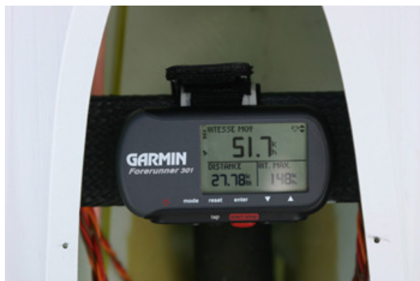
Mesures indiquées à la fin d'un vol. Ici, le planeur a parcouru presque 28 km à la vitesse moyenne de 51,7 km/h. La vitesse maximale atteinte durant ce vol a été de 148 km/h.
