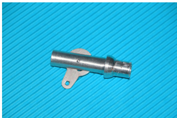
Un crochet de remorquage du commerce venant se glisser dans le nez du fuselage a été utilisé.
