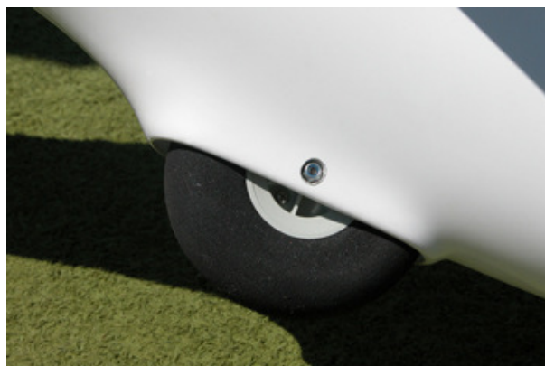
La grosse roue en mousse, maintenue en place avec une vis BTR.
