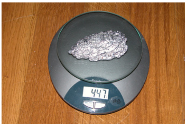
Pour obtenir le centrage, il a fallu couler un plomb d'environ 450 g !
