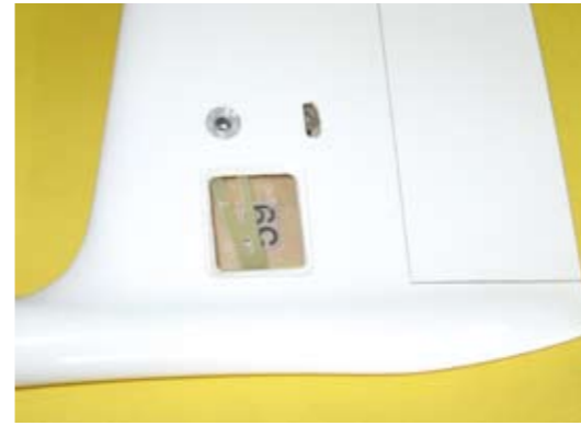
Der stabile GFK-Hebel steuert das Pendelruder an, dessen Lagerung ist ebenfalls fix fertig ab Werk eingebaut
