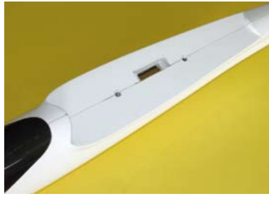
Der Rumpfübergang zur Tragfläche ist bestens vorbereitet, die Muttern für die Schraubbefestigung ab Werk eingearzt
