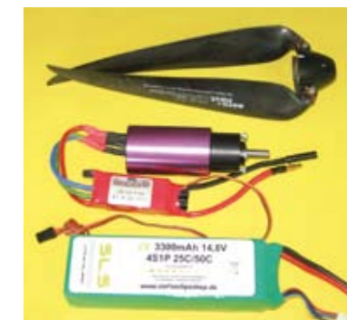
Der Antrieb besteht aus einem Hacker-Motor, Kontronik-Regler und einem 4s-LiPo von SLS mit 3.200 mAh
