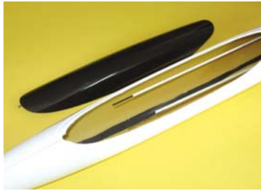
Das vordere Rumpfbot ist 2,4-Gigahertz-freundlich mit Kevlar und nur wenig CFK verstärkt
