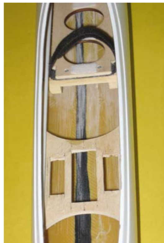
Und so sieht der Einbau mit den beiden selbst erstellten Befestigungsbrettern aus
